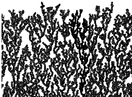
Рис. 14. Структура фрактальных агрегатов, формирующаяся при осаждении частиц на подложки. Видно последовательное убывание числа выращенных «деревьев», одно из которых выделено более темным цветом.
